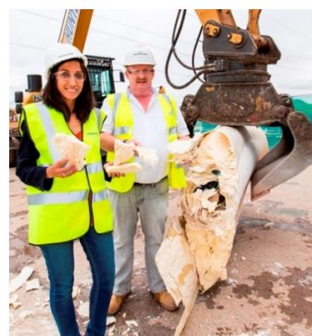
El material fibrilar obtenido en el reciclaje mecánico de palas eólicas puede usarse como fibra de refuerzo en prefabricados de hormigón, mejorando incluso sus prestaciones. La fracción heterogénea puede usarse en núcleos en aplicaciones multicapa.
